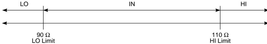
Abb. 3.10: Sortieren von 100  $\Omega$  (10%) Widerständen mit der Grenzwertprüfung.
