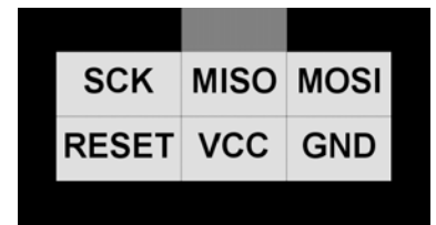
Порт SPI для программатора
