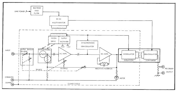
Figure 3-1. MODEL 845 BLOCK DIAGRAM
