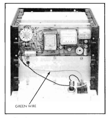
Figure 2-6. CHASSIS GROUND-WIRE LOCATION
