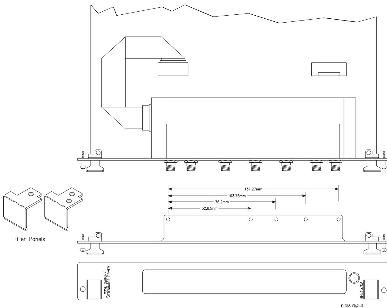
**Figure 2-7. Microwave Switch/Attenuator Installation**
