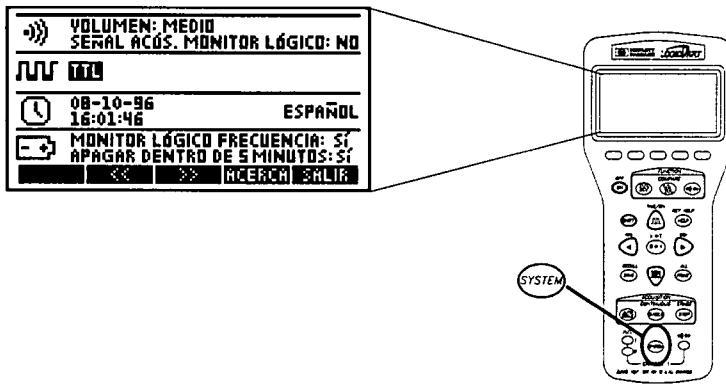
Para utilizar la configuración del sistema, mueva el marcador (texto blanco sobre un fondo negro) hacia la zona de interés y entonces cambie los valores de ese ajuste. En la anterior pantalla, se resalta el ajuste de la familia lógica, TTL.
