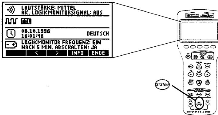
Zum Ändern der Konfiguration bewegen Sie lediglich die Hervorhebung (heller Text auf dunklem Hintergrund) auf das gewünschte Feld, und ändern Sie dann die Werte des betreffenden Feldes. Im vorliegenden Fall ist die Logikfamilie "TTL" hervorgehoben.
