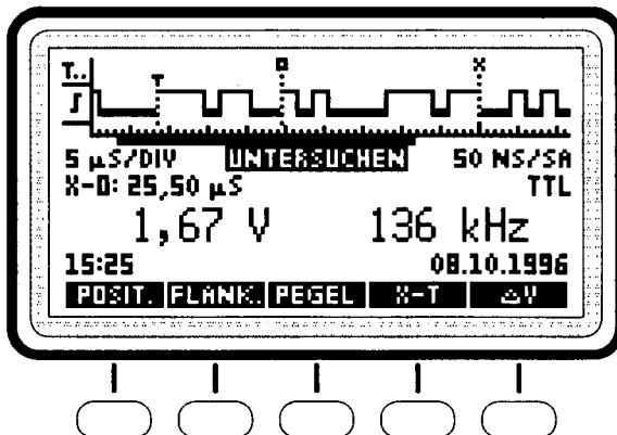
Drücken Sie die Menütaste unterhalb des Menübezeichnung, um die gewünschte Funktion auszuführen. Durch Drücken der rechten Funktionstaste wird die  $\Delta V$ -Messung aktiviert bzw. deaktiviert (siehe Seite 10).
