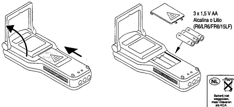
Las pilas agotadas o el proceso de sustitución de pilas no afecta a la calibración de HP LogicDart.
