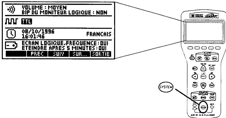
Pour modifier la configuration du système, placez la sélection (texte blanc sur fond noir) sur la rubrique ou le paramètre à modifier, puis modifiez-en la valeur. Dans l'écran ci-dessus, la rubrique sélectionnée est la famille logique, et la valeur en vigueur est TTL.
