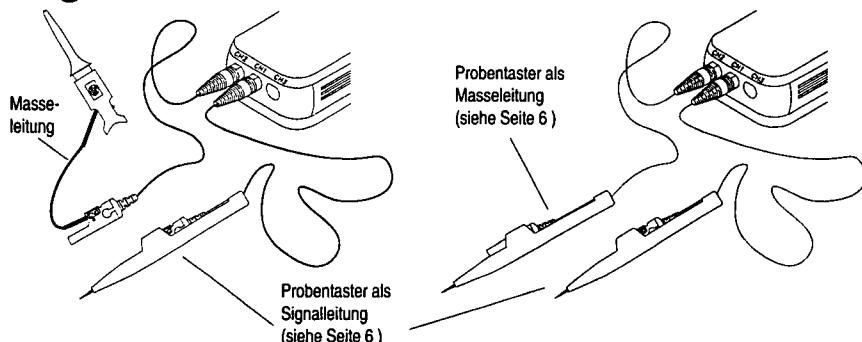
Für Messungen an niederfrequenten Signalen in Kanal 1 können Sie den Masseeanschluß von Kanal 2 oder 3 verwenden. Die Masseeanschlüsse haben einen gemeinsamen Bezugspunkt und sind für alle Kanäle gültig.
