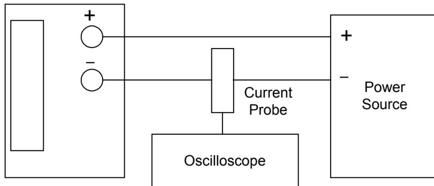
**Figure B-5. FREQUENCY / DUTY CYCLE TEST**
