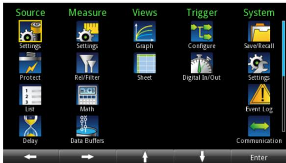
이 화면에서 소스, 측정, 그래프, 트리거 및 시스템 설정 메뉴를 선택할 수 있습니다. 이러한 메뉴에서 옵션을 선택하여 애플리케이션에 사용할 장비를 설정할 수 있습니다. 탐색 컨트롤을 스크롤하거나 화살표 키를 눌러 아이콘을 강조 표시하여 설정 항목을 선택합니다. 그런 다음 ENTER 키를 누릅니다.
