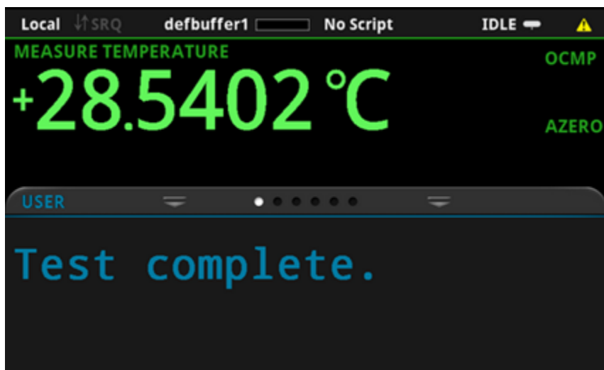
図 30: DMM7510 型での温度測定の最終結果
