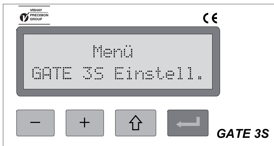
Abbildung 4. Bevor das Editieren der Parameter beginnen kann, muß GATE 3S wie in dieser Anzeige dargestellt in den Setup-Modus geschaltet werden.
