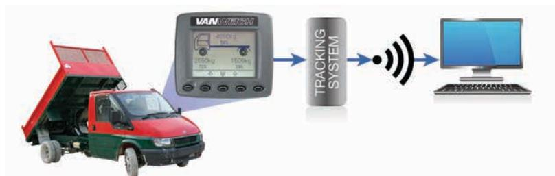
VanWeigh® comprend une sortie au niveau de l'indicateur permettant de connecter des systèmes de traçabilité et de communiquer de façon simple et fiable.
