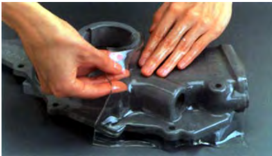
Aufformen einer PhotoStress-Beschichtung auf das Gehäuse einer Fahrzeugwasserpumpe.
