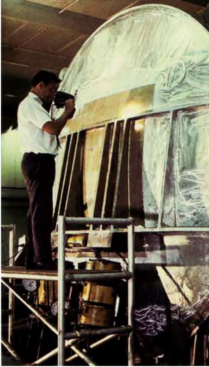
Großer Druckbehälter mit PhotoStress-Beschichtung in einem durch Rippen verstärkten Bereich.
