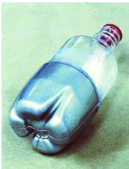
Getränkeflasche aus Kunststoff, beschichtet für den Vergleich zwischen einer PhotoStress- und einer FEM-Analyse.
