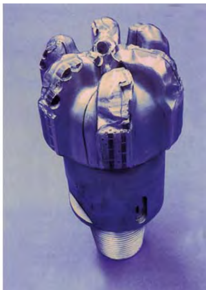
PhotoStress-Beschichtung eines Bohrkopfes aus der Ölfeldexploration.
