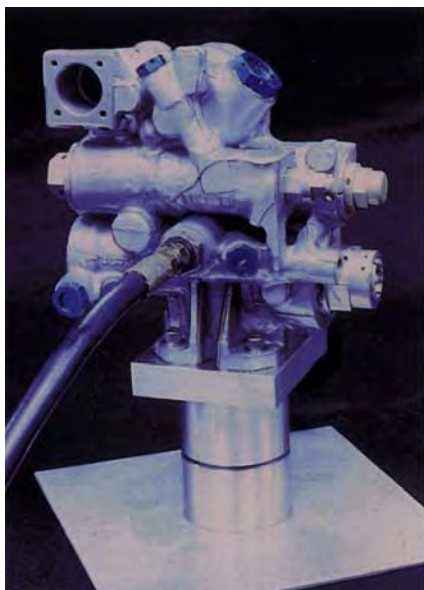
PhotoStress-Beschichtung am Gussgehäuse einer komplex geformten Kraftstoffeinspritzpumpe für eine Jetturbine.
