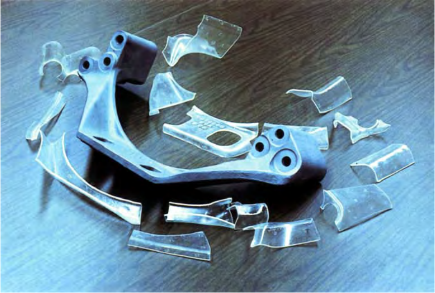
Geformte PhotoStress-Schichtschalen, fertig zum Aufkleben auf ein gegossenes Motorhalterungsteil.
