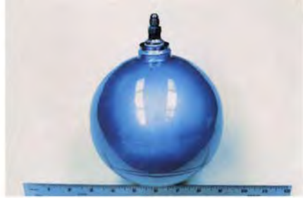
Kugeliger Druckbehälter mit PhotoStress-Beschichtung über die gesamte Oberfläche.
