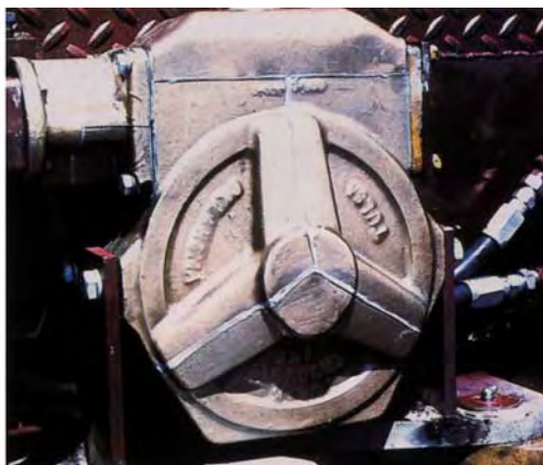
PhotoStress-Beschichtung auf dem Gussgehäuse einer Feuerwehrpumpe.
