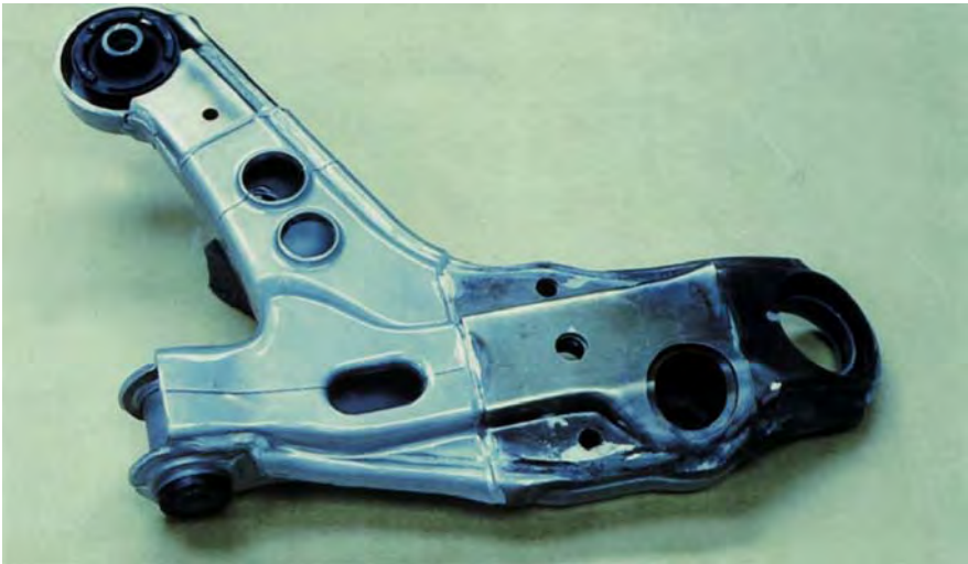
Teil einer Automobilsteuerung, beschichtet für eine PhotoStress-Untersuchung.
