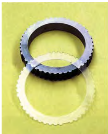
PhotoStress-Schicht zum Aufkleben auf einen Zahnring.
