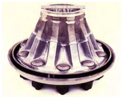
PhotoStress-Beschichtung an der Radnabe eines Hochgeschwindigkeitszugs.
