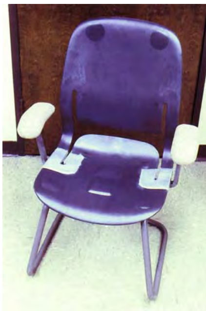
Beschichtung an einem Sessel in Bereichen, die zur Verbesserung der Flexibilität ausgelegt wurden.
