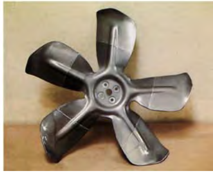
PhotoStress-Beschichtung über die Gesamtoberfläche eines Lüfterrads zur Durchführung einer dynamischen Untersuchung.
