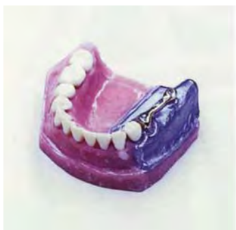
PhotoStress-Beschichtung an einem Unterkiefermodell zur Optimierung von Zahnbrücken.
