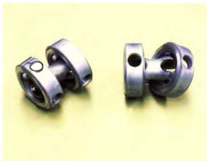
Neukonstruierte Gelenkkupplung, beschichtet und fertig für die PhotoStress-Untersuchung.
