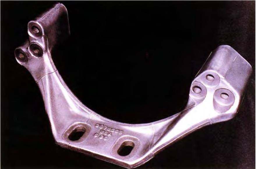
Motorhalterungsteil mit aufgeklebter Beschichtung. Die Beschichtung bedeckt das gesamte Bauteil, mit Ausnahme der Bereiche unmittelbar um die Schraubenlöcher und in Bereichen, die mit Komplementärbauteilen in physischen Kontakt kommen.
