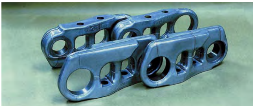
Beschichtete Kettenglieder einer Erdbewegungsmaschine.
