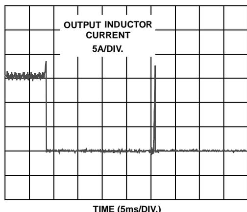
FIGURE 1. OVERCURRENT OPERATION
