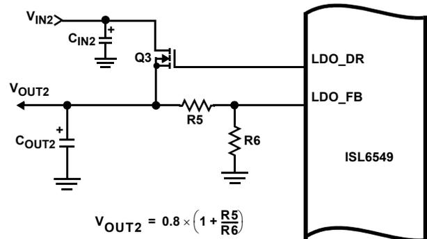
FIGURE 21. ADJUSTING  $V_{OUT2}$
