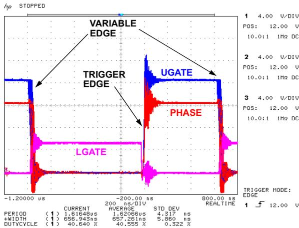
FIGURE 12. ISL6549LOW-EVAL1 JITTER MEASUREMENT; STATISTICS AND INFINITE PERSISTENCE
